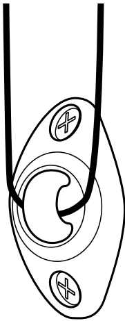
Dispositif de réglage de la tension du cordon à boucle continue
